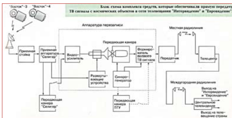
Блок-схема комплекса средств, которые обеспечивали прямую передачу телевизионного сигнала с космических объектов в сети телевидения «Интервидение» и «Евровидение»
